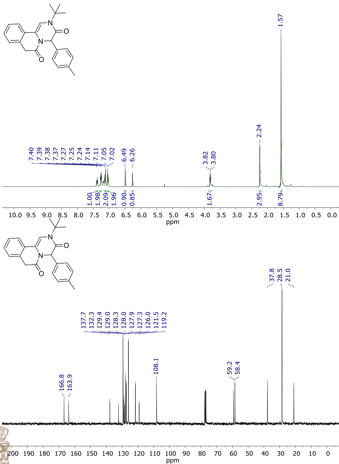
Figura 66. ^1\text{H} RMN de ^1\text{H} y ^{13}\text{C} NMR del compuesto 113t en \text{CDCl}_3 a 300 MHz para ^1\text{H} y 75 MHz para ^{13}\text{C} .
